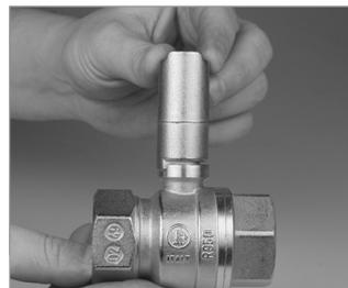
Installare la prolunga cilindrica del perno che va incastrata sull'asta della valvola a sfera, prestando attenzione al senso di apertura.
