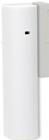
Il contatto magnetico wireless RF2MCW (bianco) è dotato di due ingressi ausiliari cablati per il collegamento e la trasmissione di ulteriori due zone indipendenti in centrale. Uno dei due ingressi può gestire contatti tapparella. Il contatto magnetico è dotato di due ampolle reed per un posizionamento flessibile del magnete esterno. Colore bianco.
