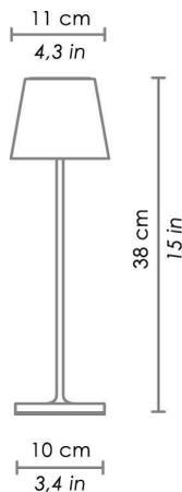
Lampada ricaricabile da tavolo dotata di base di ricarica a contatto, con corpo in alluminio verniciato, diffusore in policarbonato e fonte luminosa a LED. La collezione Poldina Pro ha un grado di protezione IP54 che la rende adatta sia all'uso interno che esterno. La durata della batteria è garantita per più di 9 ore.
